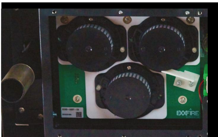
Les trois capteurs optiques permettent une détection fiable et précise.
