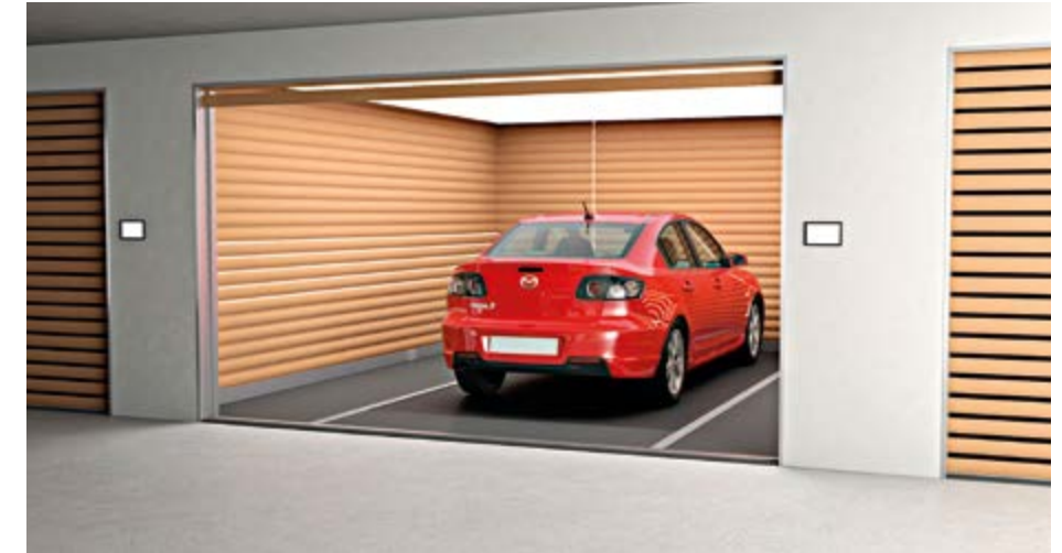
Autoa hakiessa kuljettaja vilauttaa avaintaan tunnistimessa, minkä jälkeen järjestelmä noutaa auton hyllypaikaltaan.
