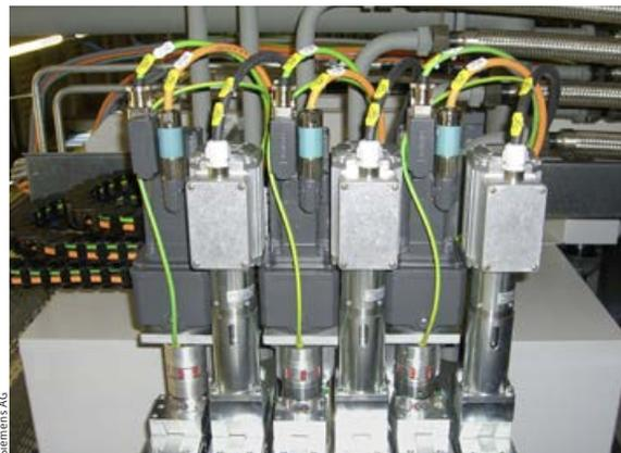
Neuer Standard an allen Transportbändern der Laminieranlagen sind perfekt auf Sinamics S120 abgestimmte Servo-Getriebemotoren Simotics S-1FK7
