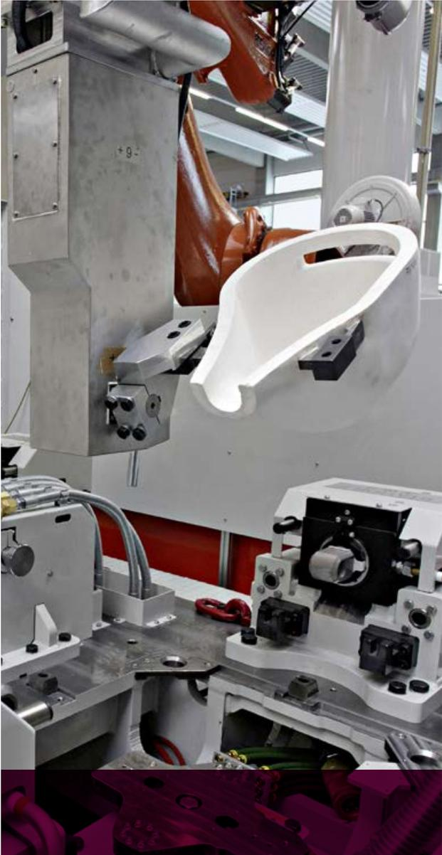
Mit dem Gießlöffel schöpft der Gießroboter das Material für die Zylinderköpfe
