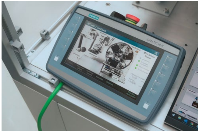
Der Einsatz des SIMATIC HMI Mobile Panels ermöglicht eine einfache und intuitive Bedienung
