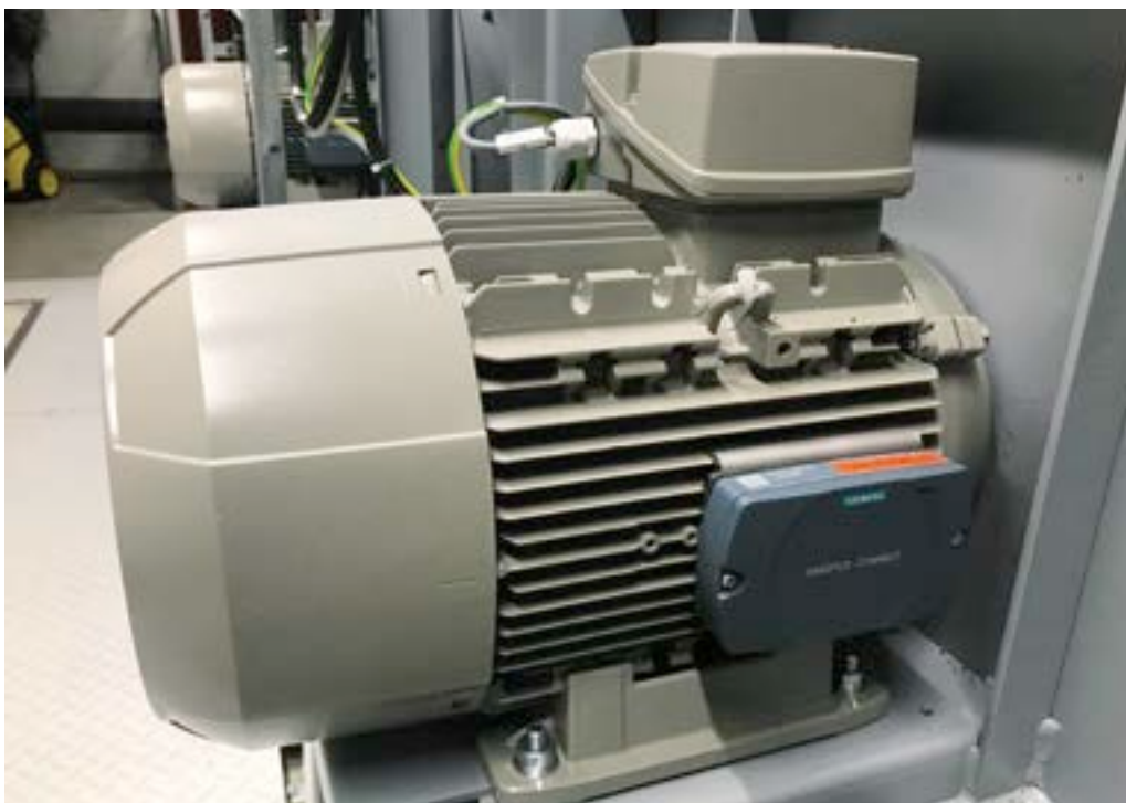
Abb.: SIMOTICS CONNECT 400 montiert an einem Siemens SIMOTICS General Purpose Motor
