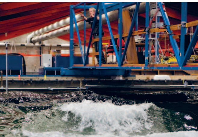
DHI råder over en række hydrauliske forsøgs-laboratorier. De benyttes til at designe og afprøve havne og andre kystnære konstruktioner, fx fundamenter til havvindmøller.
