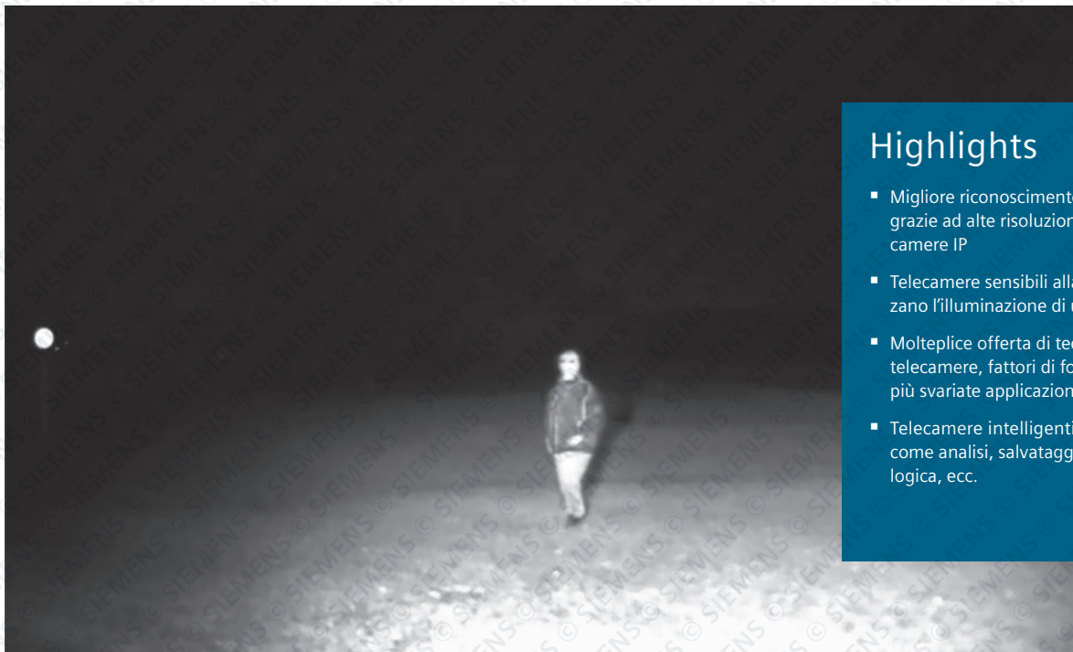
Telecamera diurna/notturna in modalità bianconero con illuminazione a infrarossi
