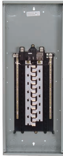
Serie ES monofásico, interruptor principal 125-225 A, 30-70 circuitos
