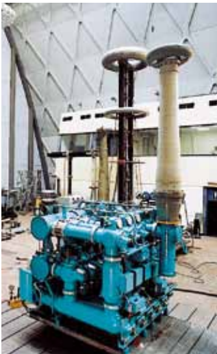
Hochspannungsprüfung einer kompletten Versandbaugruppe
