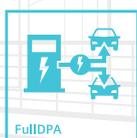
SICHARGE D автоматически адаптирует процесс зарядки в зависимости от количества подключенных автомобилей для достижения двух целей. Во-первых, станция всегда выдает полную доступную мощность, а во-вторых, подстраивается под требуемую мощность конкретного электромобиля.
