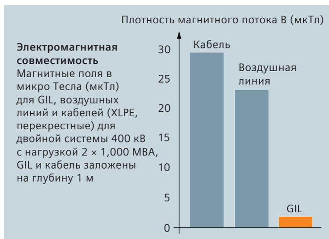
Рис. 2.5-2: Сравнение магнитных полей для различных высоковольтных систем передачи электроэнергии
