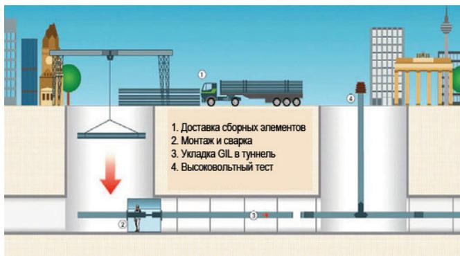
Рис. 2.5-7: Технология прокладки ГИЛ в туннеле
