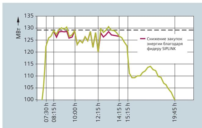
Рис. 2.3-4: Снижение суточных пиков в распределительной системе населенного пункта как результат обеспечения энергии от другой распределительной системы, подключенной через SIPLINK
