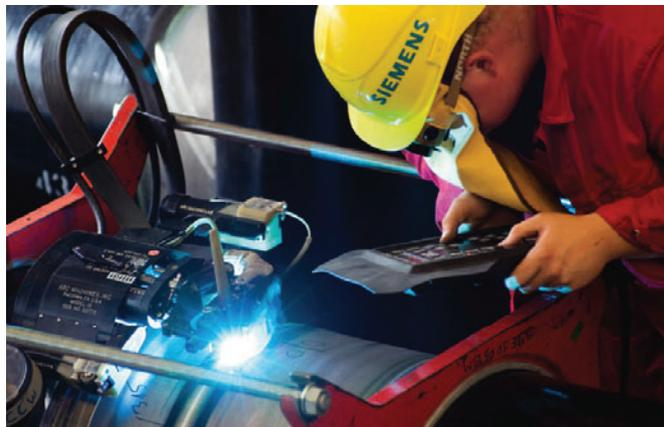
Рис. 2.5-5: Орбитальная сварка труб ГИЛ
