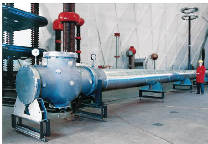
Рис. 2.5-4: Образец ГИЛ на диэлектрических испытаниях в лаборатории Сименс
