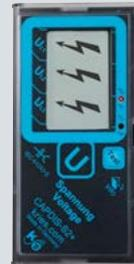
**Интегрированная система проверки наличия напряжения CAPDIS-S1+, -S2+**
