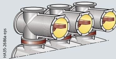
Исполнение сборной шины до 3150 А, Пример 8DA10
