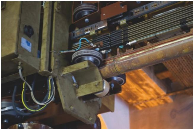
IWLAN-Antennen sorgen auch an Segmentübergängen für unterbrechungsfreie drahtlose Kommunikation. Die Rapid-Roaming-Funktionalität realisiert Übergabezeiten von unter 32 Millisekunden zwischen den Access Points.
