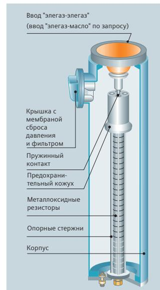
Рис. 4.5-5: ОПН с элегазовой изоляцией (ОПН для КРУЭ)
