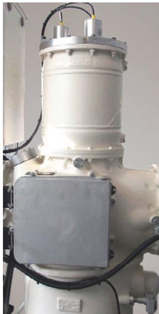
Рис. 4.6-14: RC-делитель напряжения для КРУЭ 145 кВ
