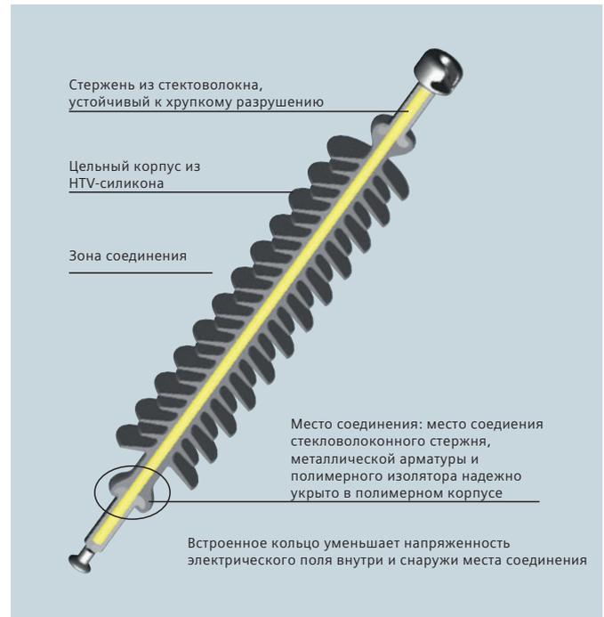
Рис. 4.10-3: Изолятор типа 3FL - превосходная конструкция, удовлетворяющая самым высоким требованиям
