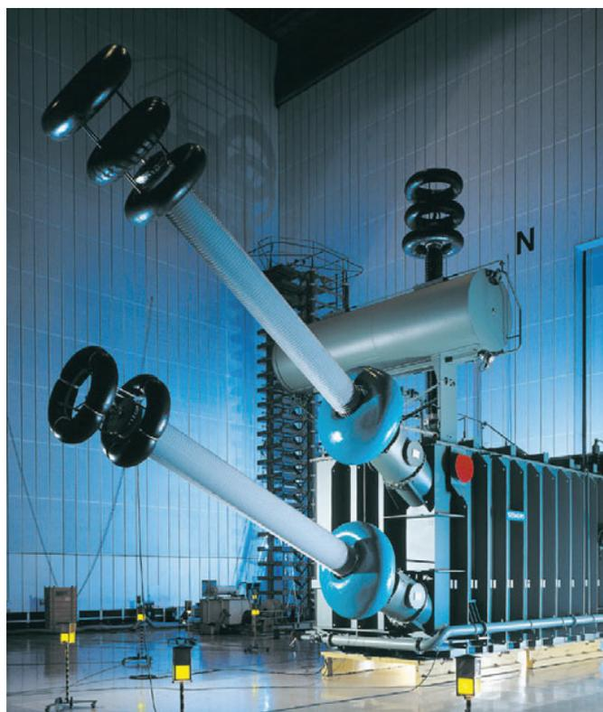
Рис. 4.8-6: Трансформаторный ввод постоянного тока 500 кВ проект «Три ущелья», Китай
