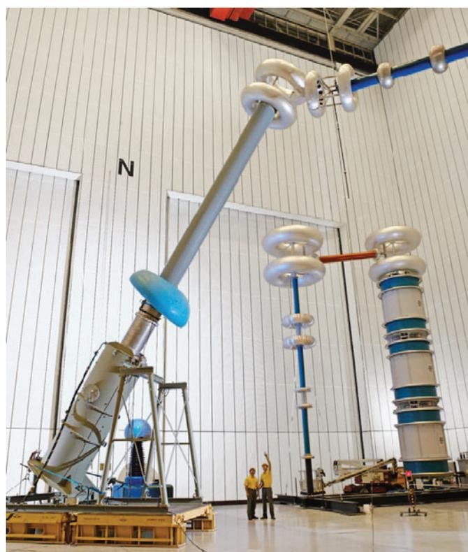
Рис. 4.8-5: Трансформаторный ввод постоянного тока 800 кВ проект Юньнань-Гундун, Китай
