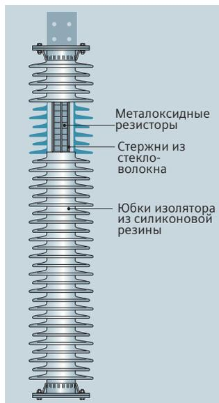
Рис. 4.5-4: ОПН клеточной конструкции типа ЗЕЛ
