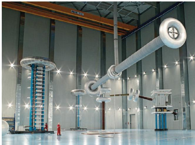
Рис. 4.8-8: Проходной изолятор постоянного тока 800 кВ проект Юньнань-Гуандун, Китай
