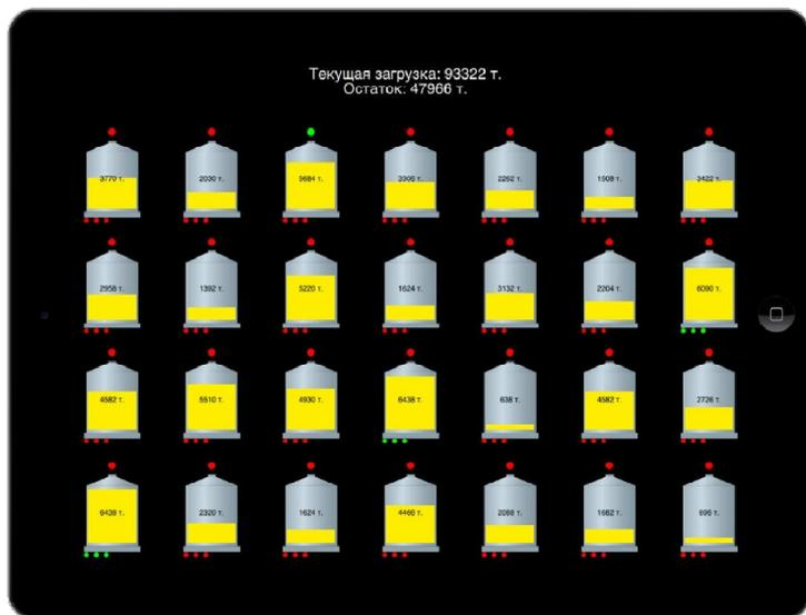
**Впервые в России АСУ ТП, содержащая более 5 000 сигналов, построена на базе Simatic S7-1500 с распределенной периферией Simatic ET200SP, объединенной сетью Profinet.**
