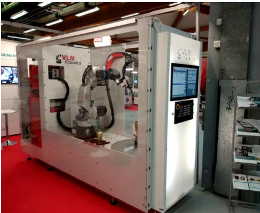
Machine Comp@qt de fabrication additive métallique ; développée dans le cadre d'un PIA Nouvel Aquitaine (NC Siemens, robot COMAU , logiciel NX ...).
