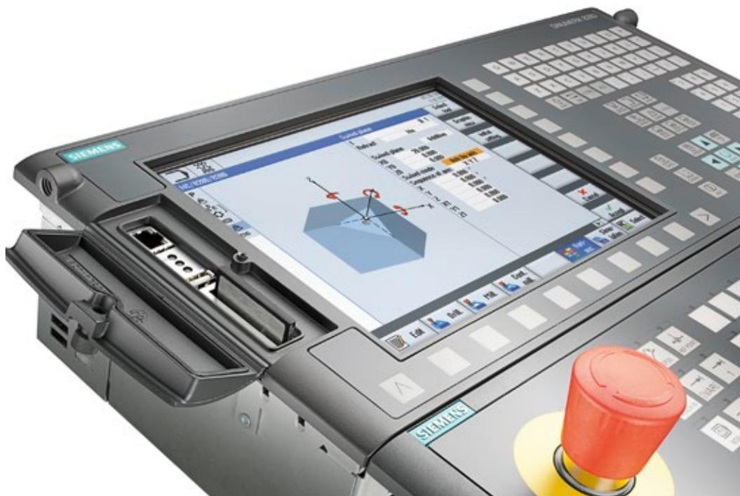
ou la rectification. Deux axes automatiques supplémentaires peuvent être utilisés par exemple, pour des magasins d'outils ou des convoyeurs de pièces. Enfin, variateurs, moteurs d'axes et de broches sont désormais disponibles en deux versions. Haut de gamme avec les SINAMICS S120 + 1FK7 et 1PH8, mais aussi une gamme économique et adaptée aux machines moins exigeantes : Variateurs Combi + 1FK2 + 1PH3.
