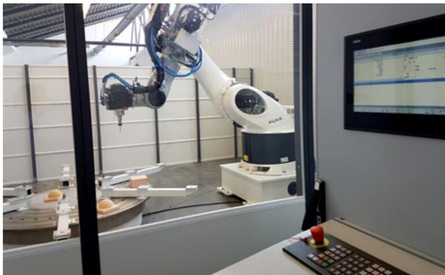
Cellule d'usinage multifonctions de pièces en composite (jusqu'à 4 m de diamètre) de Nimittech.
