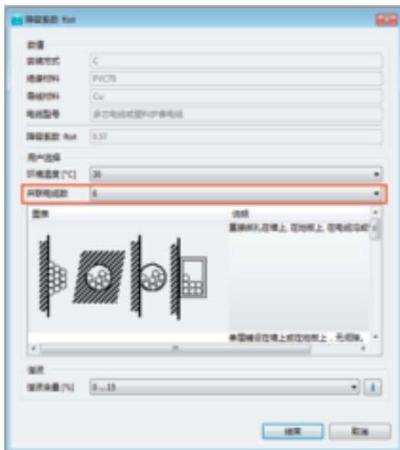
在这里，必须输入电缆 / 电线总数加上需要并行敷设的电缆 / 电线数目，以作为并行线路的数目。在需要敷设单芯电缆时，这种相加只应包括含有多个单芯电缆或线路的交流线路或三相线路的数目。这意味着在这种情况下，将把两个或三个带电导体计为一个线路。
