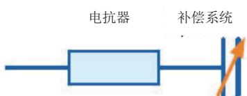
在高于该谐振频率时，串联谐振电路变为感性电路。因此，在这种情况下，不能再激发谐振。低于其谐振频率时，该电路变为容性，用于无功功率补偿。
