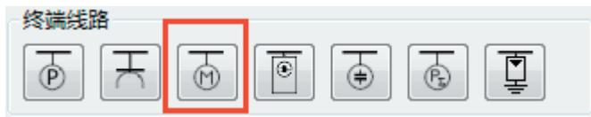
与其它耗电设备相比，电动机回路的特性不同。因此，应在 SIMARIS design 中对电动机回路单独考虑。这意味着电动机在电网图中有自己的图标。这样就能够在设计过程中，相应地考虑电动机回路中的这些特殊情况。
