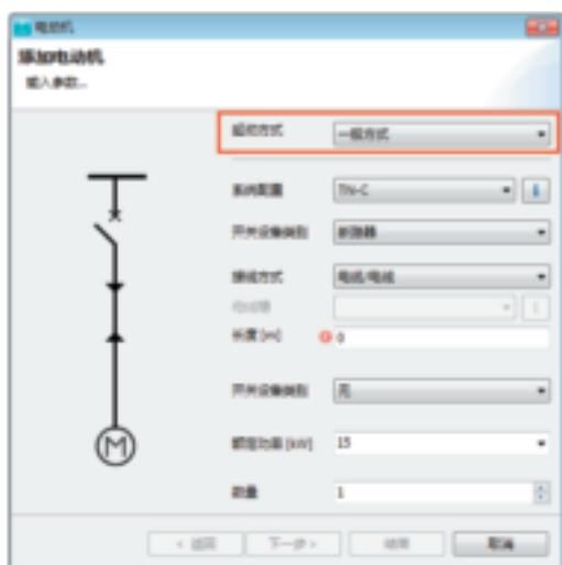
在将电机添加到电网图中之后显示的选择窗口中，可在“起动方式”字段中选择“一般方式”选项。进行这一选择后，可通过断路器（“无熔断器”）来保护电动机。此时不能采用熔断保护技术。
