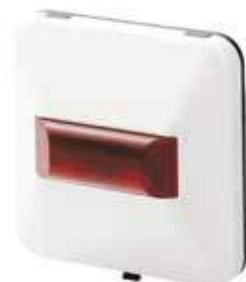
Consente la rapida individuazione dei rivelatori in stato di allarme, che sono difficilmente accessibili oppure posizionati in luoghi poco visibili, per es.: sopra controsoffitti, stanze chiuse, etc. Contiene unità luminose costituite da LED. L'indicatore indirizzabile FDCAI221 è connesso alla linea di rivelazione FDnet/ C-NET ed è liberamente programmabile.
