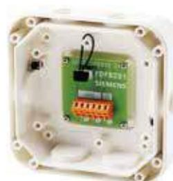
La base è costituita da una custodia in plastica robusta rinforzata con fibra di vetro che consente l'installazione del rivelatore. La base contiene morsettiere senza viti, morsetti ausiliari isolati e sei passaggi cavo M20.
