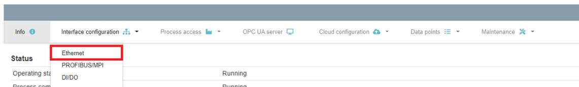
1. Controllare l'indirizzo IP del CloudConnect7, ovvero la "Process Interface (P2)". Questo indirizzo IP deve appartenere alla sottorete di automazione, correggere di conseguenza l'indirizzo.
