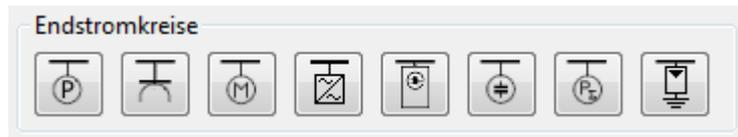
Generell können Endstromkreise in den Netzplan eingefügt werden, indem man das Icon des benötigten Endstromkreises in der Bibliothek selektiert, mit der Maus im Netzplan entlang einer Niederspannungs-Haupt- oder Unterverteilung einen passenden Einfügepunkt (gelbes Rechteck) sucht und den Endstromkreis durch Drücken und Halten der linken Maustaste, anschließendes Wegziehen der Maus vom Einfügepunkt und schließlich Loslassen der Maustaste am gewählten Einfügepunkt einfügt.
