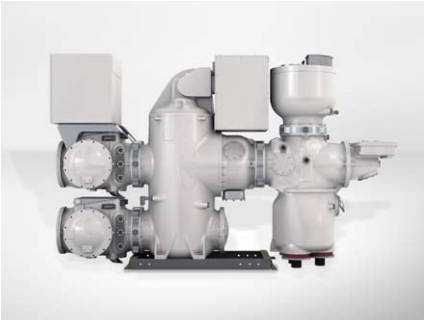
Kompakt durch dreipolige Kapselung: 8DN8 145 kV, Kabelfeld mit Doppelsammelschiene
