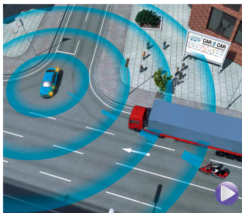
CAR-TO-X. Jobban áramlik a forgalom, ha kommunikálnak az autók a forgalmi lámpákkal és más autókkal.
