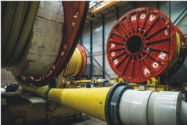
Einige Rohre sind 12 bis 14 Kilometer lang, und sie werden auf gewaltigen Spulen gelagert und damit über das Werksgelände transportiert
