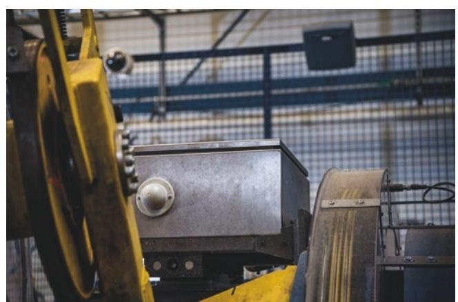
An der Wand ist ein Access Point SCALANCE W montiert. Zwei WLAN-Antennen des Typs ANT-795-6MN sind auf der Drehvorrichtung einander gegenüber angeordnet. Wenn das Signal gerade einmal 32 ms lang ausfällt, führt die Maschine sofort einen Nothalt aus.
