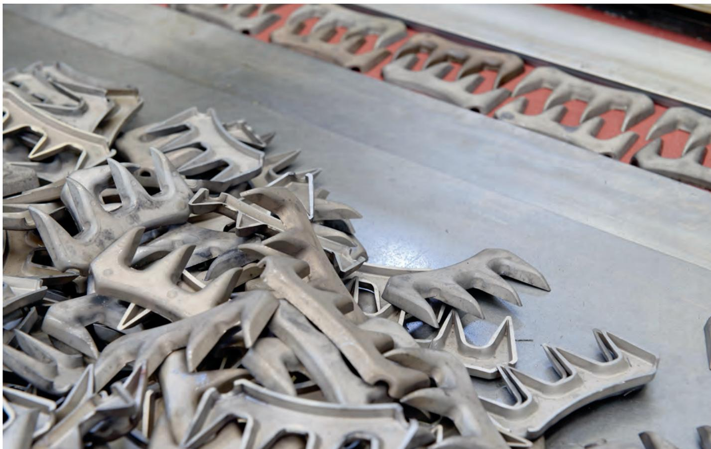
Hier werden Schermesser geschliffen, die später zum Schafscheren eingesetzt werden.
