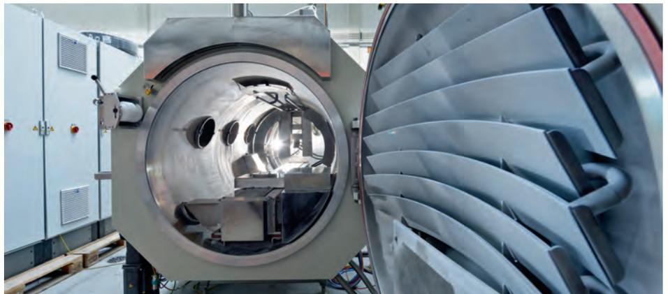
Herzstück der Beschichtungsanlage ist die rund drei Meter lange Vakuumkammer, ein doppelwandiger wassergekühlter V2A-Behälter mit einem Volumen von 3500 Litern.
