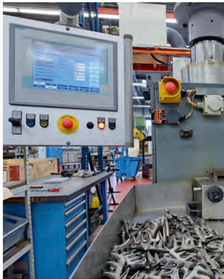
In der Durchlaufschleifmaschine werden Kleinteile in grossen Mengen geschliffen. Beim Retrofit erhielt die Maschine eine neue Steuerung. Die Mechanik hingegen ist robust und musste nicht erneuert werden.
