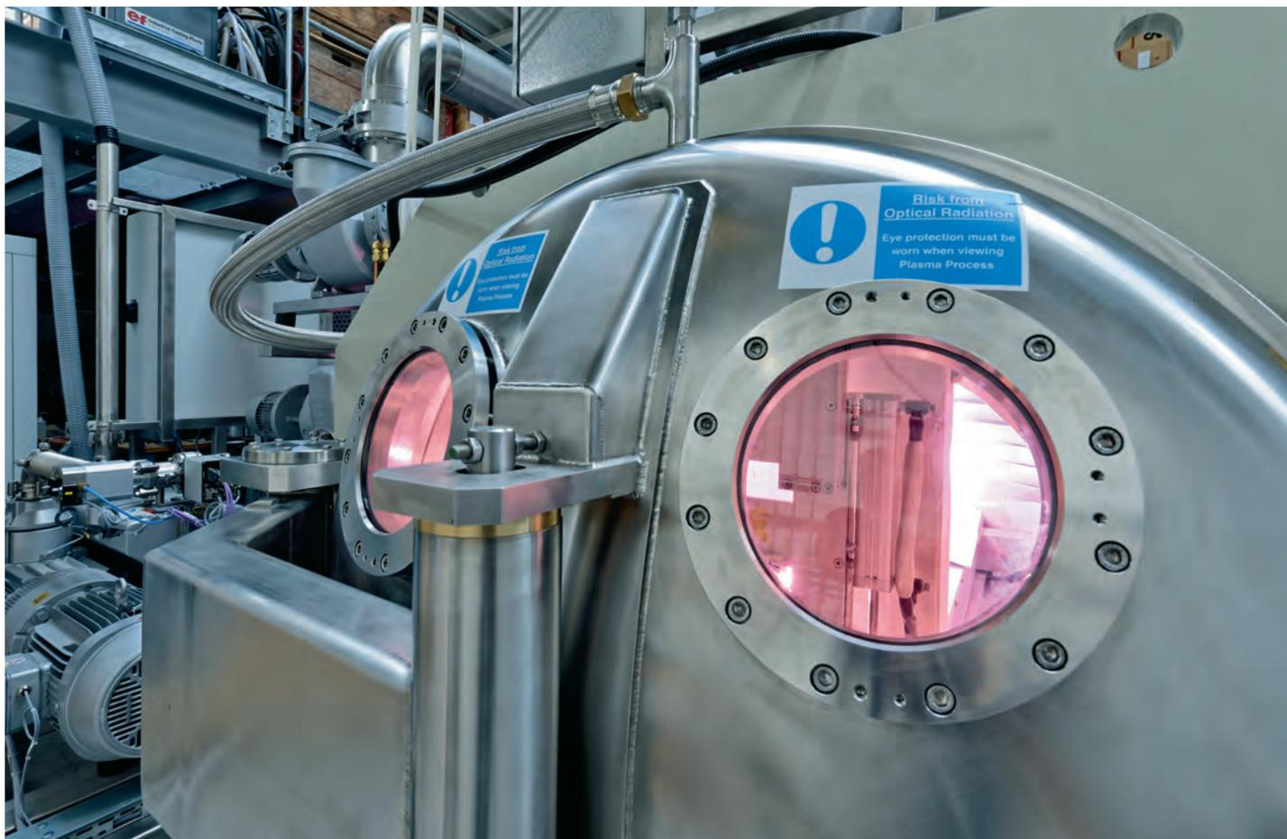
Im Inneren der Vakuumkammer ist die pneumatische Einrichtung für die vertikale Verschiebung des Brenners sichtbar.
