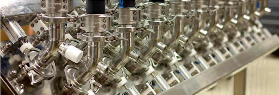
Die Rohr-Station während der Montage vor Ort in China. Im Vordergrund ist die Isolierung des RFID-Transponders aus weissem Teflon zu sehen, der es ermöglicht, das zu transportierende Pulver zu bestätigen.
