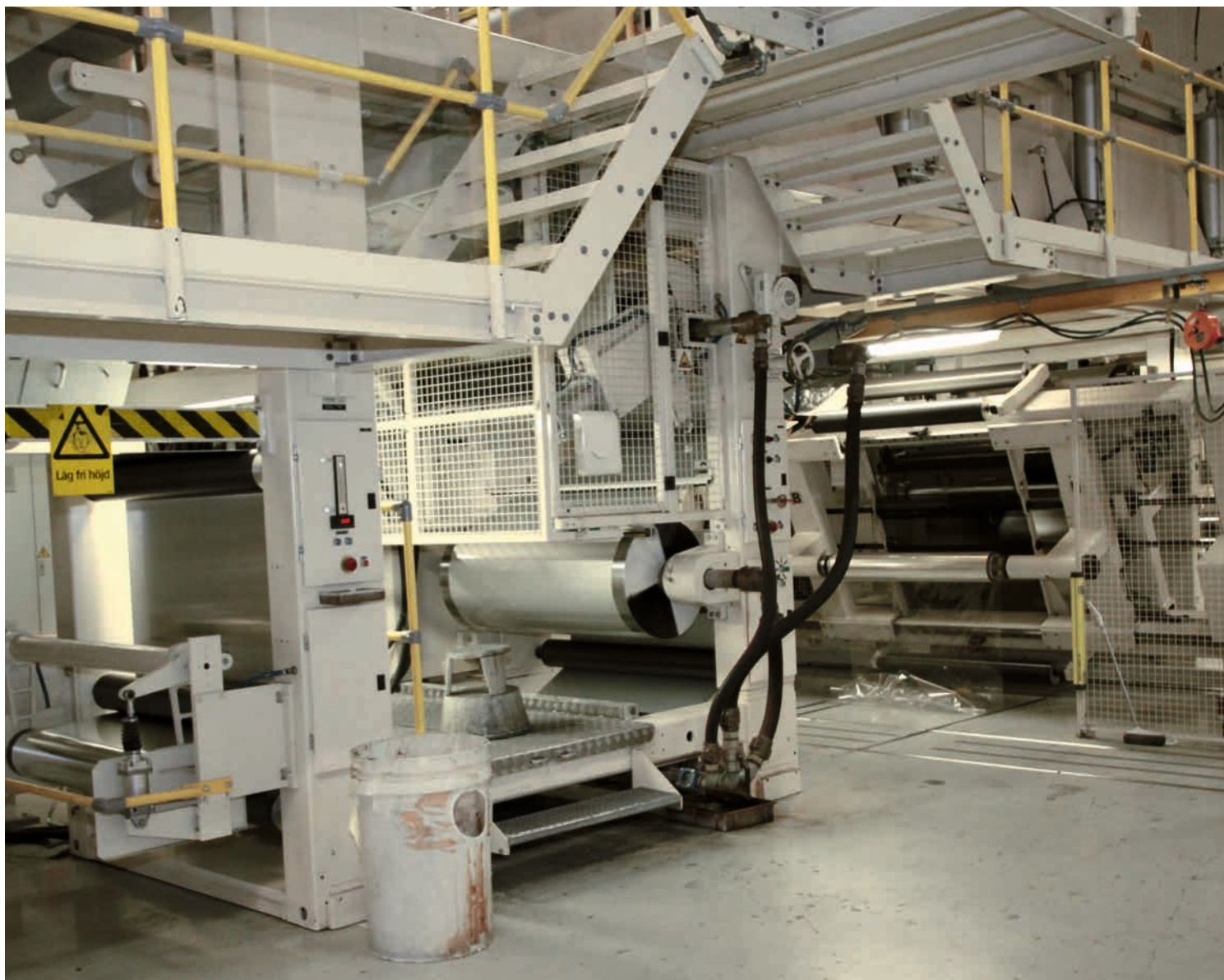
I lamineringsmaskinen limmas en plastfilm och någon typ av metallfilm, aluminium eller koppar, ihop för att till exempel användas till kabel eller, som just här, till växthusgardiner.
