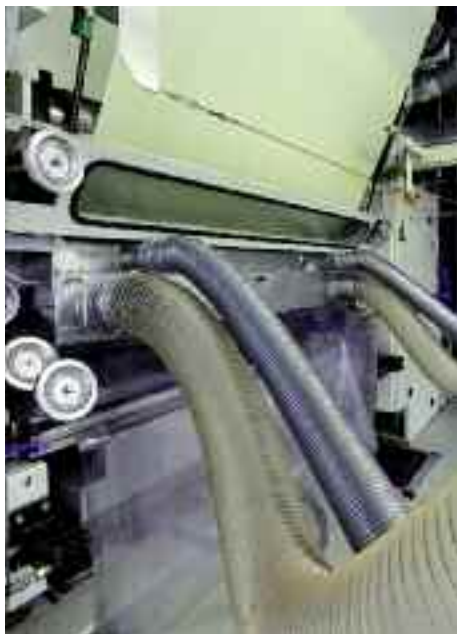
Die Auftragsstation für die Silikonisierung des Trägermaterials.
