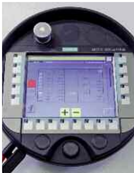
Das Simatic Mobile Panel 277 begleitet das Bedienpersonal direkt an der Maschine. Schnelles Eingreifen erhöht die Sicherheit zusätzlich.
