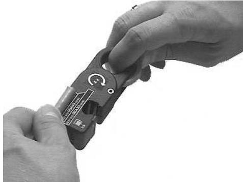
2. ストリッパの口が開いた方を上に向け、親指で抑えた位置までケーブルをストリッパに挿入します。
