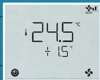
Настройка относительной (+/-3 K) и абсолютной уставок
