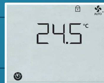
Блокировка кнопок Видны только активные кнопки
