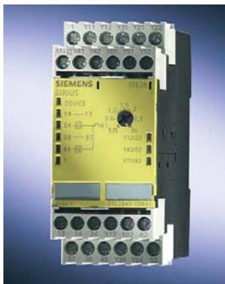
dung kann heute mit nur einem Multifunktionsgerät realisiert werden, denn die Geräte vereinen mehrere Funktionen in einem Gehäuse. Zwei Sensoreingänge, z. B. für Not-Halt und Schutztür, eine mit Schlüsselschalter umschaltbare Sicherheitslogik sowie je zwei elektronische und zwei Relais-Freigabekreise machen es möglich. Die platz- und kostensparenden Multifunktionsgeräte 3TK2845 gibt es in 5 Varianten.
