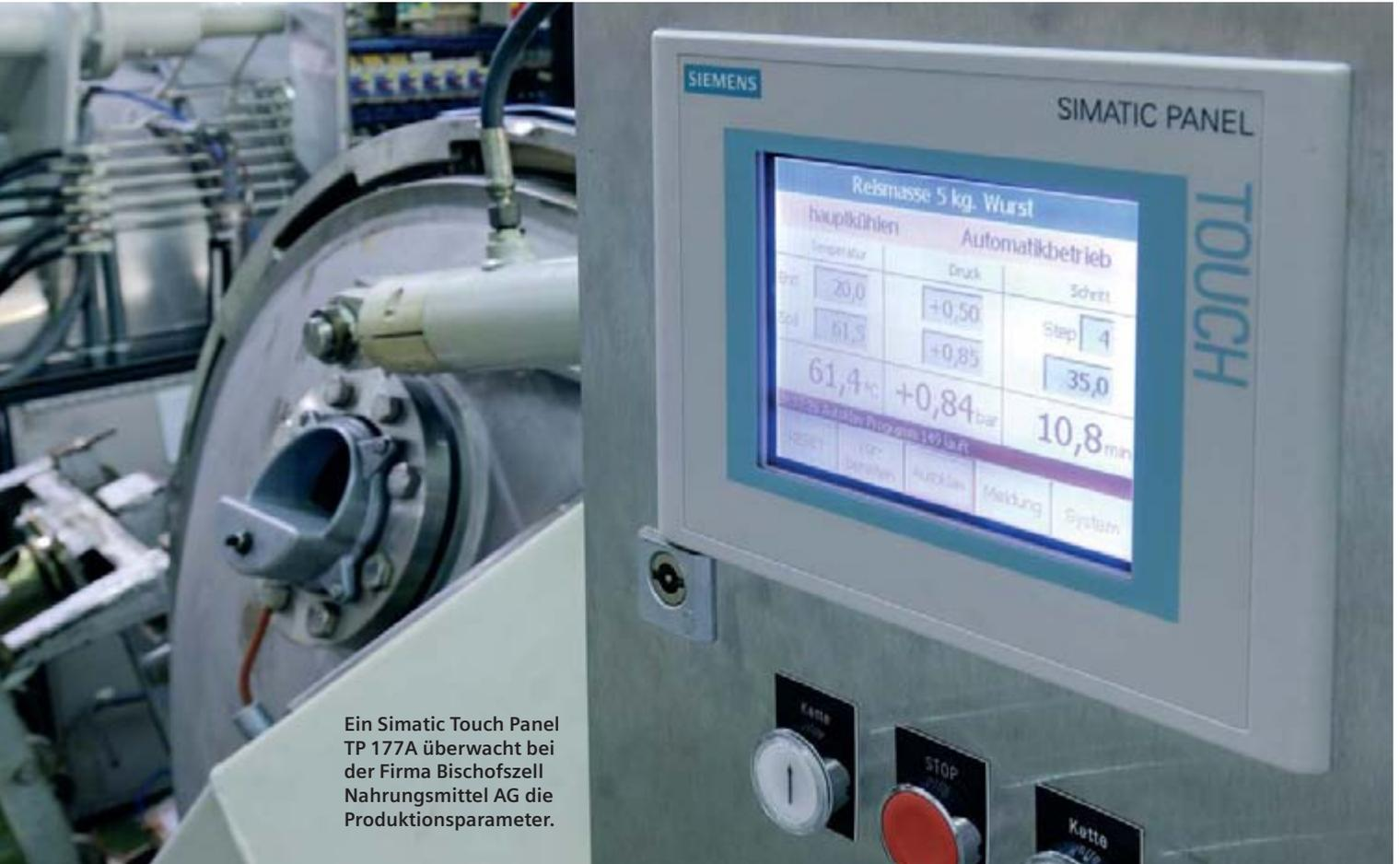
Ein Simatic Touch Panel TP 177A überwacht bei der Firma Bischofszell Nahrungsmittel AG die Produktionsparameter.
