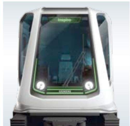
Die Möglichkeit eines fahrerlosen Betriebes, einzigartig auch in Kombination mit konventionellem Fahrerbetrieb, gewährleisten höchste Energieeffizienz durch Synchronisierung der Brems- und Beschleunigungsvorgänge im Gesamtsystem – regenerierte Bremsenergie kann sofort von gleichzeitig beschleunigenden Fahrzeugen genutzt werden.
