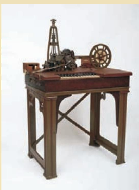
Hughesov telegraf, izdelan v Siemensovi tovarni,
