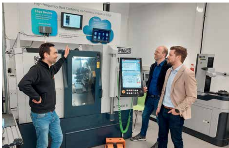
Щефан Трабезингер (л.) от ТУ Грац обяснява как може да се използва Siemens Industrial Edge за директен анализ на данните от CNC-системата SINUMERIK в метало-режеща машина на фирма „Шпинер“
