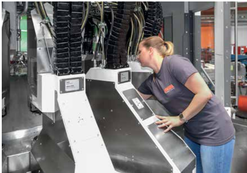
Лесен достъп до металоуреждащата машина с ЦПУ със 79 оси въпреки компактната конструкция
