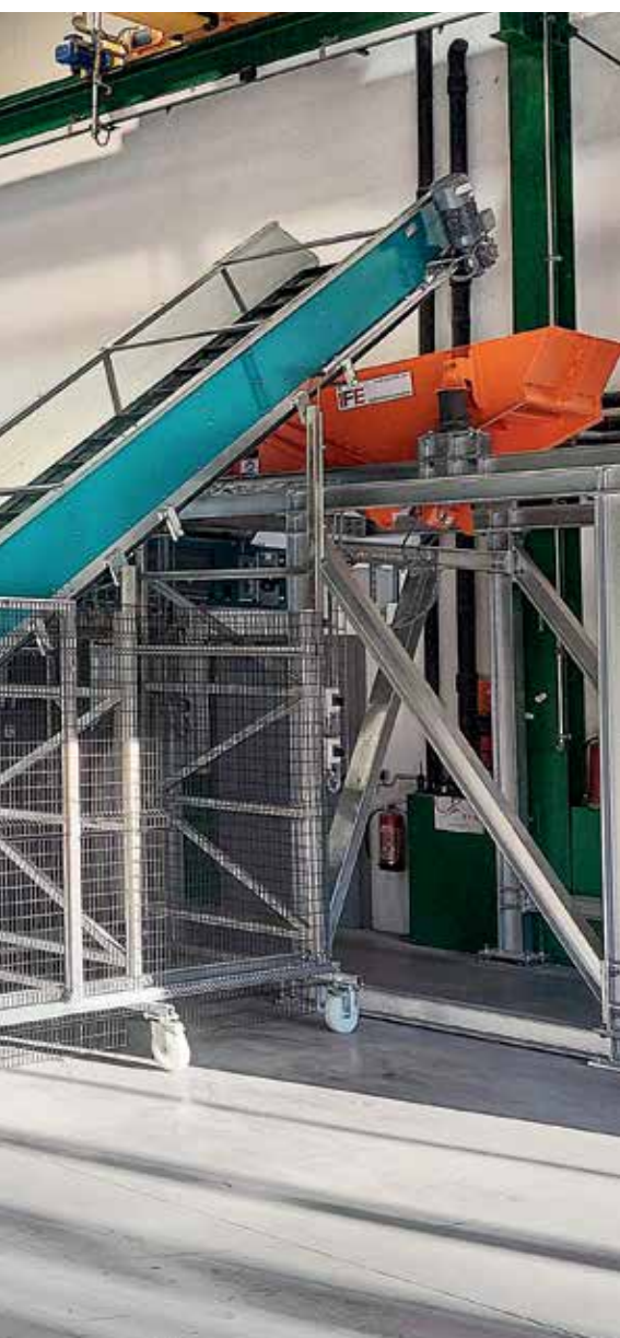
Експерименталната инсталация в лабораторията за дигитални изследвания на отпадъците към МГУ Леобен може да анализира и сортира отпадъци
