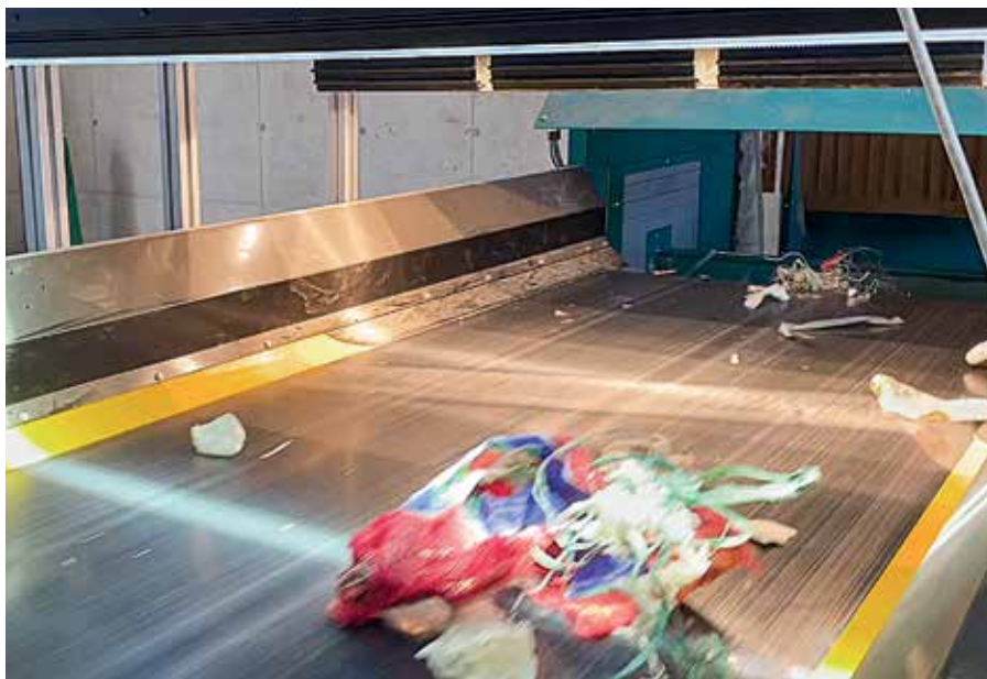
Тук отпадъците попадат в обсега на монтираните над конвейерната лента датчици, които заедно със софтуерната платформа за анализ ревизират процеса на сортиране
