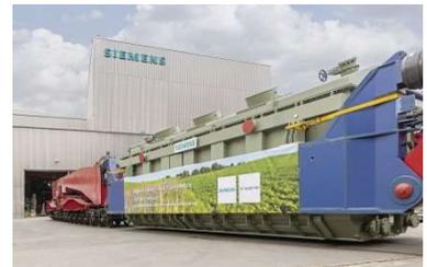
Der 420-kV Leistungstransformator mit einer Bemessungsleistung von 400 MVA im Prüffeld und bei der Auslieferung.
