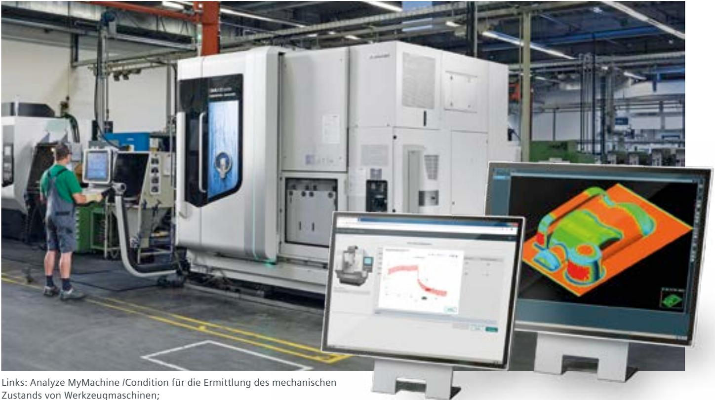
Links: Analyze MyMachine /Condition für die Ermittlung des mechanischen Zustands von Werkzeugmaschinen;
