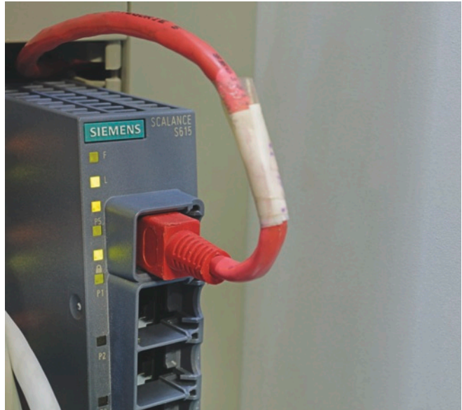
Schnittstelle zum SINEMA Remote Connect bei ACSR sind die Security Modules SCALANCE S615, die sich rückwirkungsfrei ins Betreiber Netzwerk integrieren ließen.
