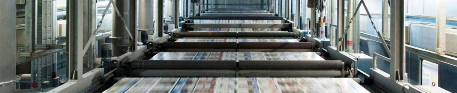
Am Standort Nürnberg von Burda Druck laufen vier Tiefdruckrotationen mit einer Druckbreite von bis zu 3,64 Meter
