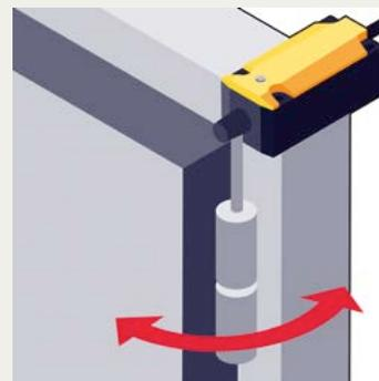
Schwenkbare Türen und Klappen, mit fester formschlüssiger Verbindung zwischen Schalter und Türscharnier, Schaltwinkel 10°
