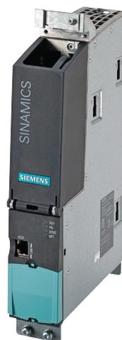
La unidad de control CU320-2 puede aceptar la interfaz PROFIBUS o PROFINET. La interfaz también contiene entradas y salidas digitales y analógicas. Se pueden instalar tarjetas de expansión que permitan la comunicación a través de CANopen o EtherNET / IP.
