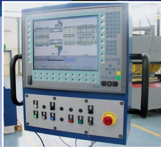
Die neue NC-Maschine Francesca FC 32M 3300 MILL von Forvet kann Glasscheiben bis zu einer Größe von 3300 Millimeter x 8000 Millimeter bearbeiten
