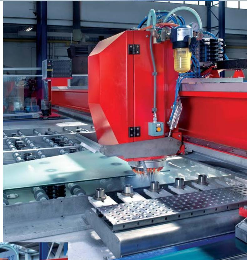
**Mit der kompakten Motorspindel fräst Benteler auch große Glasscheiben schnell und exakt**
