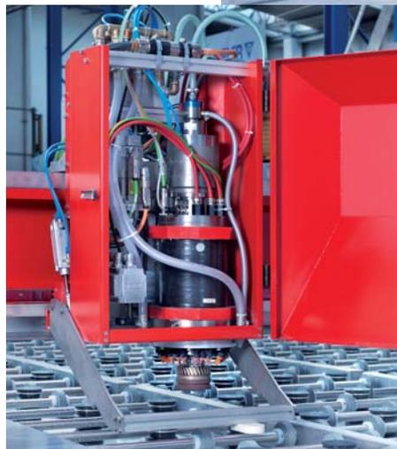
**Die Motorspindel enthält sämtliche mechanischen Elemente, wie Sensorik, Kühlung und Werkzeugspannvorrichtung**
