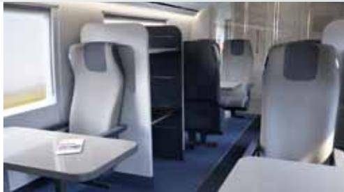
Haltegriffe an den Sitzen, ein taktiles Leitsystem mit Sitzplatznummern in Braille-Schrift und Leisten am Fahrzeugboden geben Sicherheit und Orientierung beim Einstieg und während der Fahrt.
