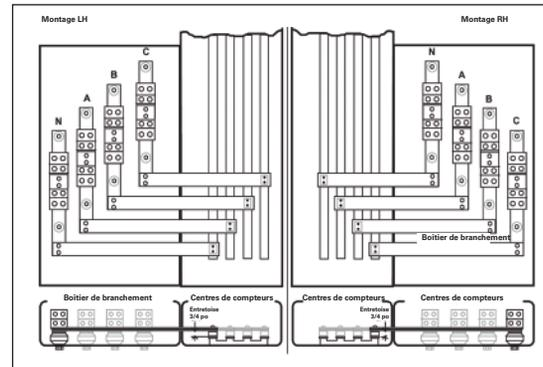
Remarque : Pour un boîtier de branchement d'alimentation directe de 1 200 A, l'assemblage standard est pour le montage à gauche. Pour le montage à droite, les barres omnibus et les supports isolés doivent être déplacés vers l'autre ensemble d'orifices, identifié par un « R » avant l'installation murale.
