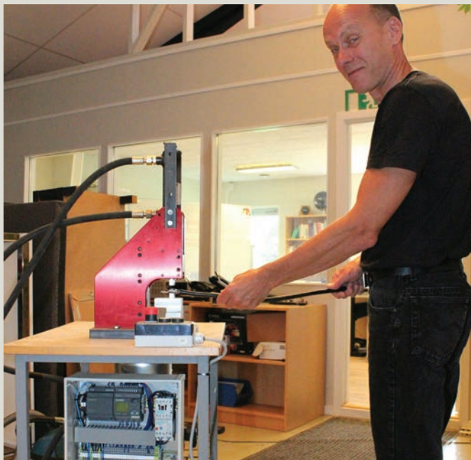
Per Erin Madsen har til eget brug bygget en presse til kabelsko. Den er naturligvis styret af en LOGO!, hvor en analogindgang anvendes til trykmåling.
