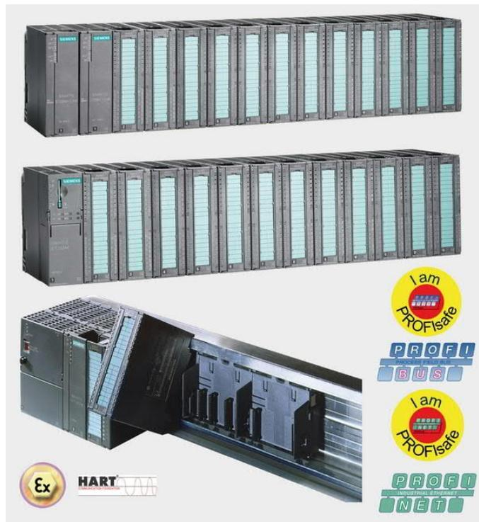
Между стандартными и F-модулями необходима установка разделительного модуля, обеспечивающего защиту F-модулей от перенапряжений. При этом F-модули должны получать питание от собственного блока питания. В системах, отвечающих требованиям уровня безопасности SIL2, разделительный модуль может не устанавливаться.
