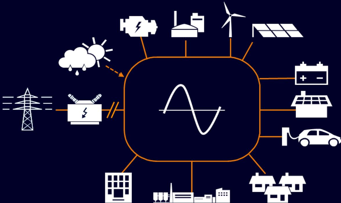
Et Microgrid er et geografisk begrænset område i elnettet, der indeholder både egen energiproduktion fra forskellige kilder, forskellige typer forbrugere og evt. energilagring. Dets primære funktion er at opretholde balancen mellem energiproduktion og forbrug, og det kan fungere med eller uden tilslutning til det øvrige elnet, dvs. i ø-drift.
