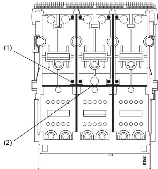
(1) 8 Befestigungslöcher für selbstschneidende Schrauben
