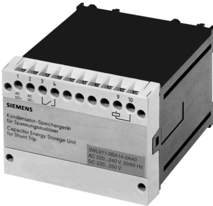
Das Kondensator-Speichergerät 3WL9111-0BA... ist ein Vorschaltgerät für die Spannungsauslöser. Es kann ein Auslöser mit einem dauernd anliegenden AUS-Kommando angesteuert werden. Es ermöglicht mit seinem Energiespeicher, nach einem Ausfall der Betriebsspannung innerhalb der Speicherzeit, ein einmaliges Ausschalten des Leistungsschalters mit dem Spannungsauslöser.
