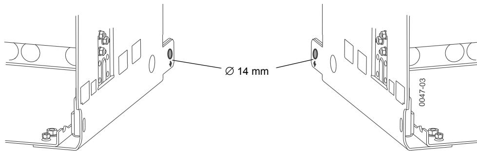
Bei BG II 4000 A wird der Einschubrahmen nur durch die Schrauben zur Befestigung im Schaltschrank geerdet.
