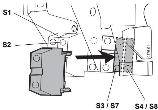
Die Anschlussleitungen der Meldeschalter sind an die Hilfsleiterklemmblöcke X5 und X6 entsprechend dem Verdrahtungsplan → (Seite 8-3) anzuklemmen.
