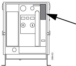
Max. Bemessungsnennstrom des Leistungsschalters
