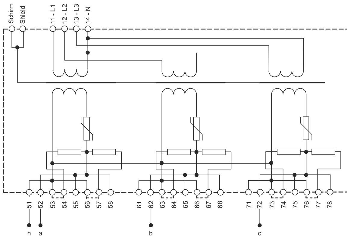
Die Genauigkeit der Spannungswandler ist von der Anzahl der angeschlossenen Messfunktionen pro Spannungswandler abhängig:
