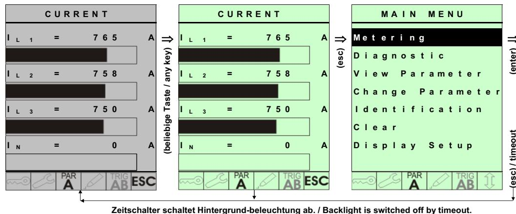
Die Dauer, nach der die Hintergrundbeleuchtung abgeschaltet wird und der Bildschirm wieder die Ströme anzeigen kann unter „Einstellungen“ ⇒ „Default SCR“ zwischen 30 und 600 Sekunden eingestellt werden.
