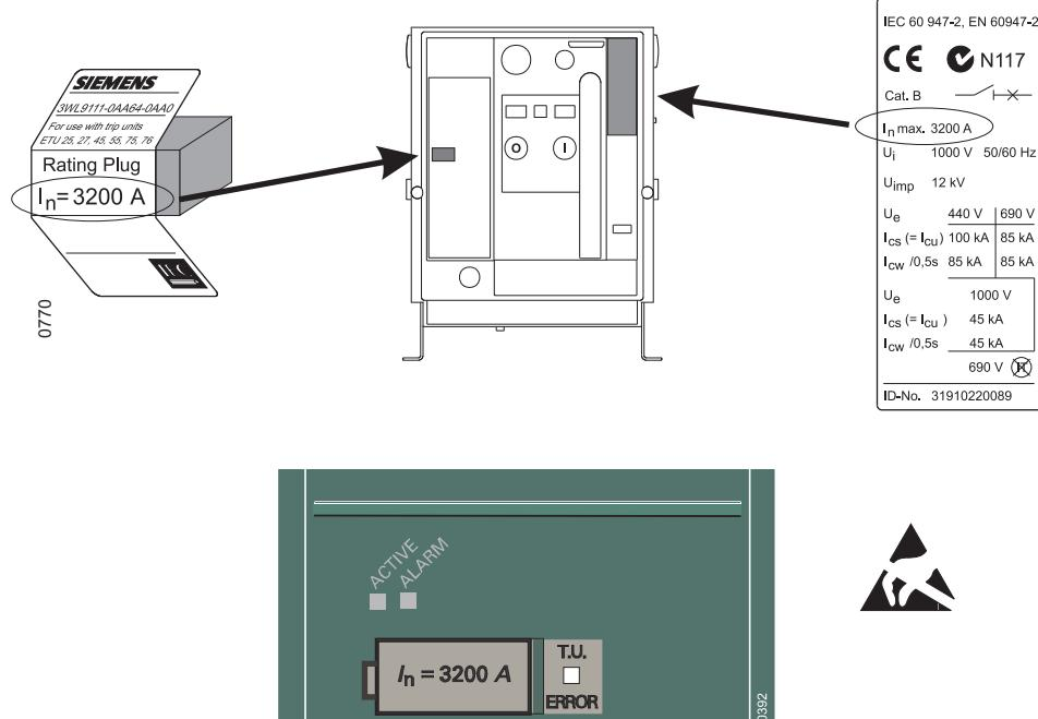
Das Bemessungsstrommodul bestimmt den Bemessungsstrom innerhalb eines gewissen Bereiches für eine gegebene Baugröße des Leistungsschalters.
