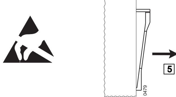
Display um 180° gedreht einsetzen und einrasten
