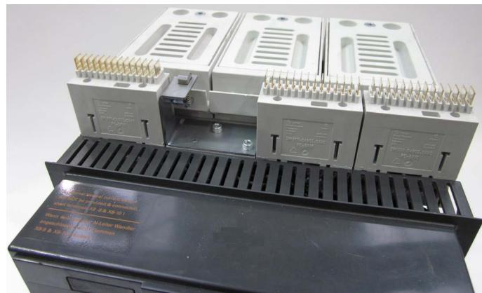
**COM15-Modul am Festeinbauschalter montieren**
