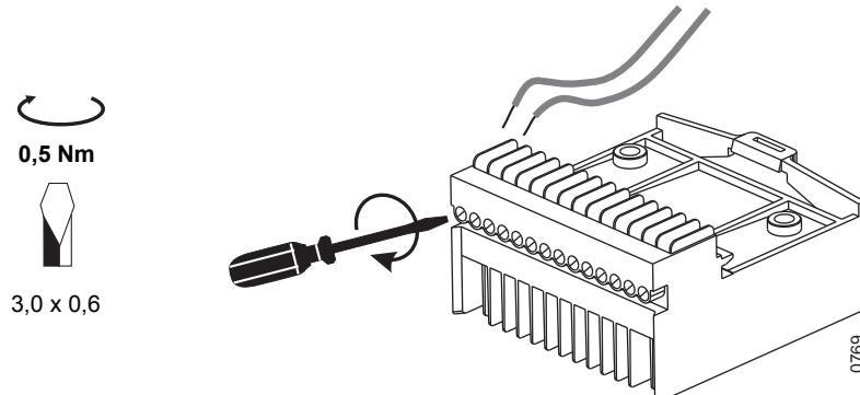
Einteilige Schleifkontaktmodule benötigen keinen Hilfsstromstecker. Die Leitungen werden direkt am Schleifkontaktmodul angeschlossen.
