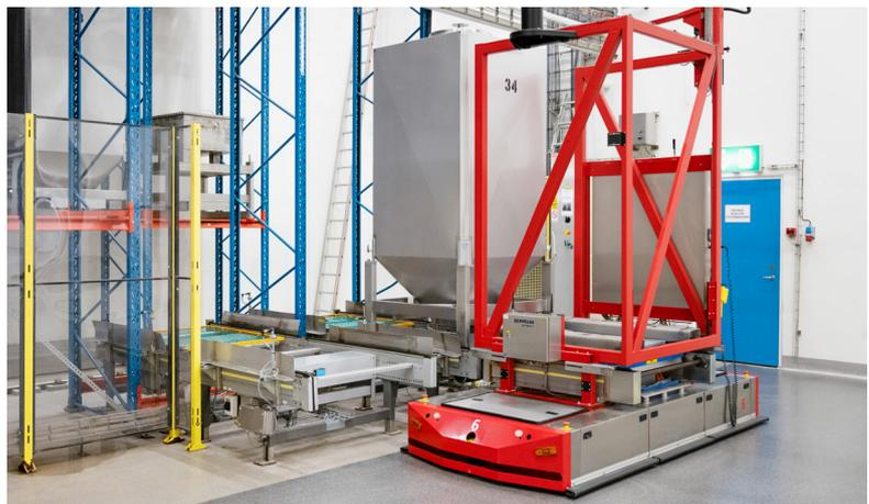
Im Wiege- und Ausgabebereich können AGVs Gewichtsmessungen in Echtzeit mittels eines drahtlosen Netzwerks zurück zur SPS kommunizieren. Dieses Netzwerk ist zum größten Teil über die SCALANCE W-Lösung realisiert.
