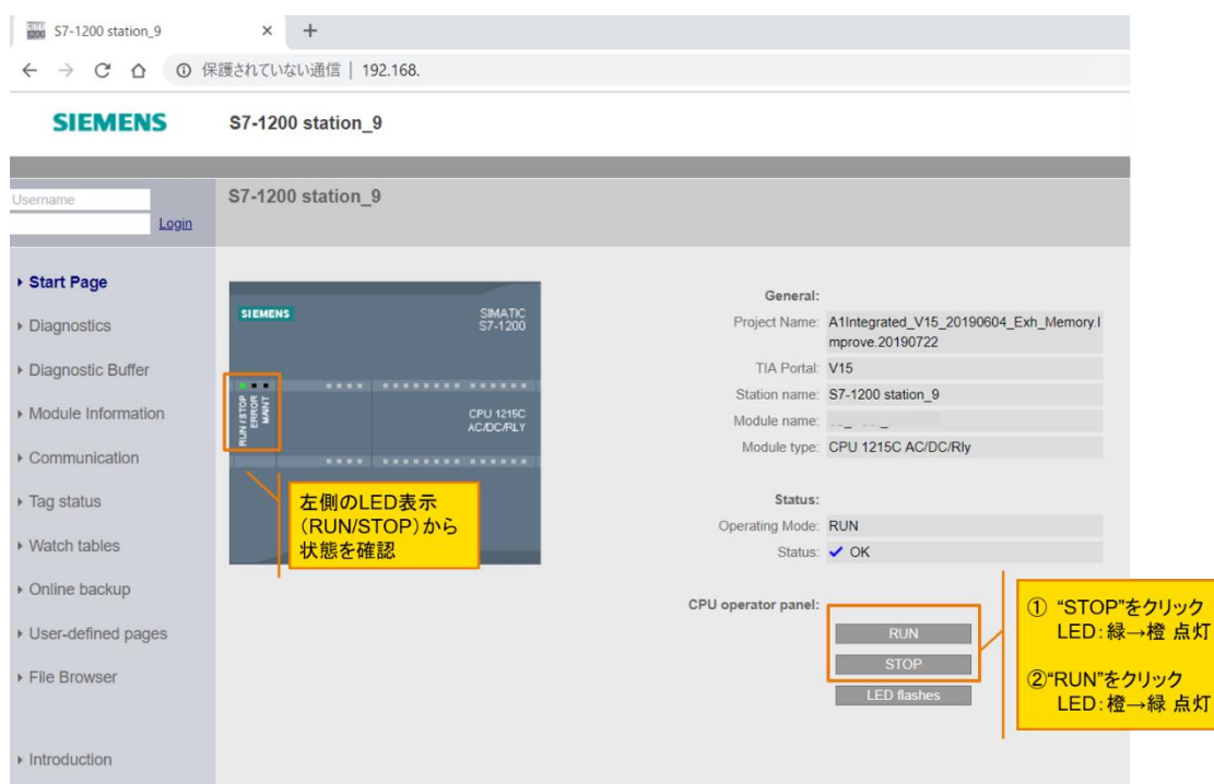
図5-2-7. PLC再起動画面
