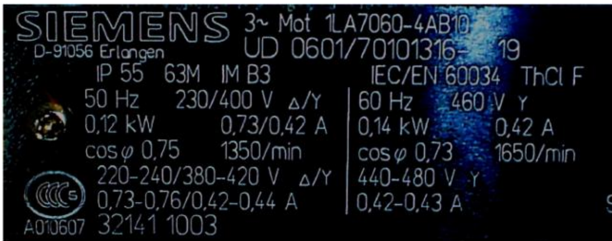
Rysunek 3-1 Tabliczka znamionowa silnika użytego w przykładzie
