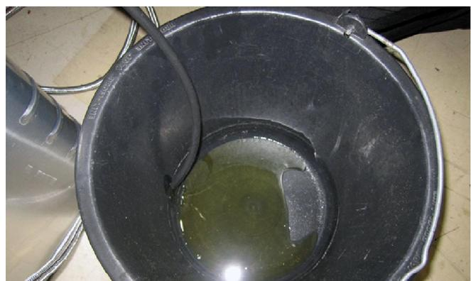
2.4. Verbinden Sie die eine Seite des zweiten armierten Schlauchs mit dem **Koffer** (**unterer Anschluss**) und die andere Seite mit dem **schwarzen Gummischlauch mit der Schnellkupplung**. Das andere Ende des schwarzen Gummischlauchs hängt in einem Ölaufanggefäß. Öffnen Sie den roten Hahn und lassen Sie ca. 3 l Öl ab.
