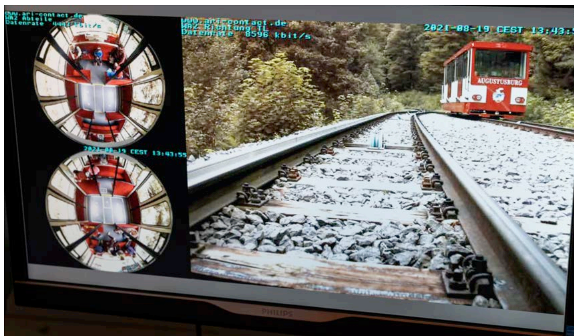
Hochaufgelöste Videobilder von der Strecke und dem Wageninneren werden über das IWLAN-Netzwerk übertragen.
